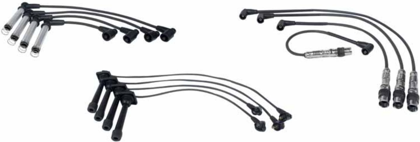
Los cables MAHLE, con núcleo supresor/reactivos son fabricados con filamentos de kevlar o fv impregnados con compuesto silicona/ferromagnético con espiralado en su entorno de hilo de aleación níquel-cromo y con resistencia óhmica entre 4 a 7 Kohms/metro. El sistema espiralado crea una inductancia mejorando la energía de la chispa en la bujía de ignición y anulando las interferencias. Puede ser usado en temperaturas extremadamente bajas (-40 °C) o altas (220 °C).
