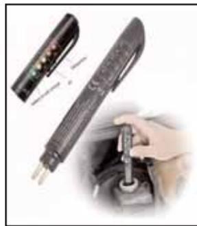
Talleres especializados disponen de herramientas digitales para verificar el estado (refractómetro o tester digital).
