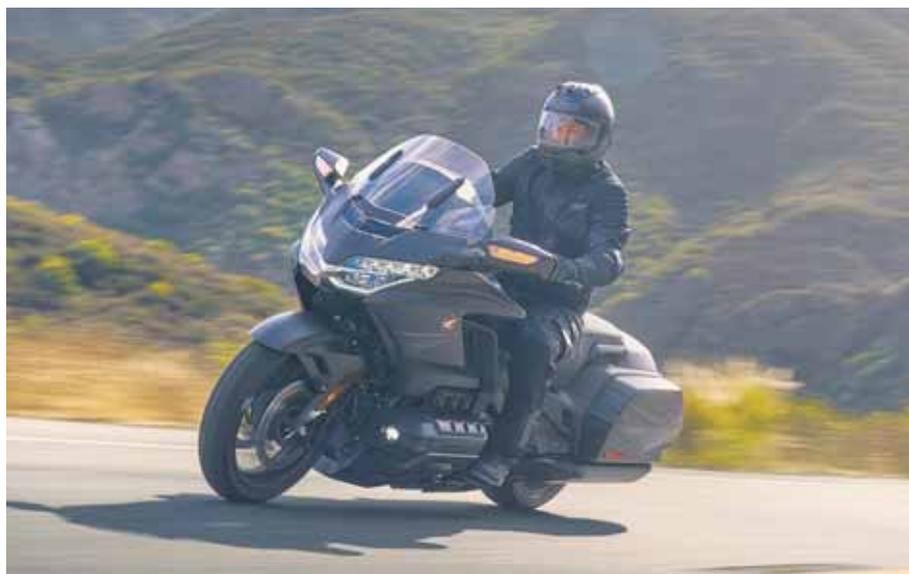
**La Honda Gold Wing (2025) tiene un motor de seis cilindros. La caja es automática de siete cambios, con doble embrague.**
