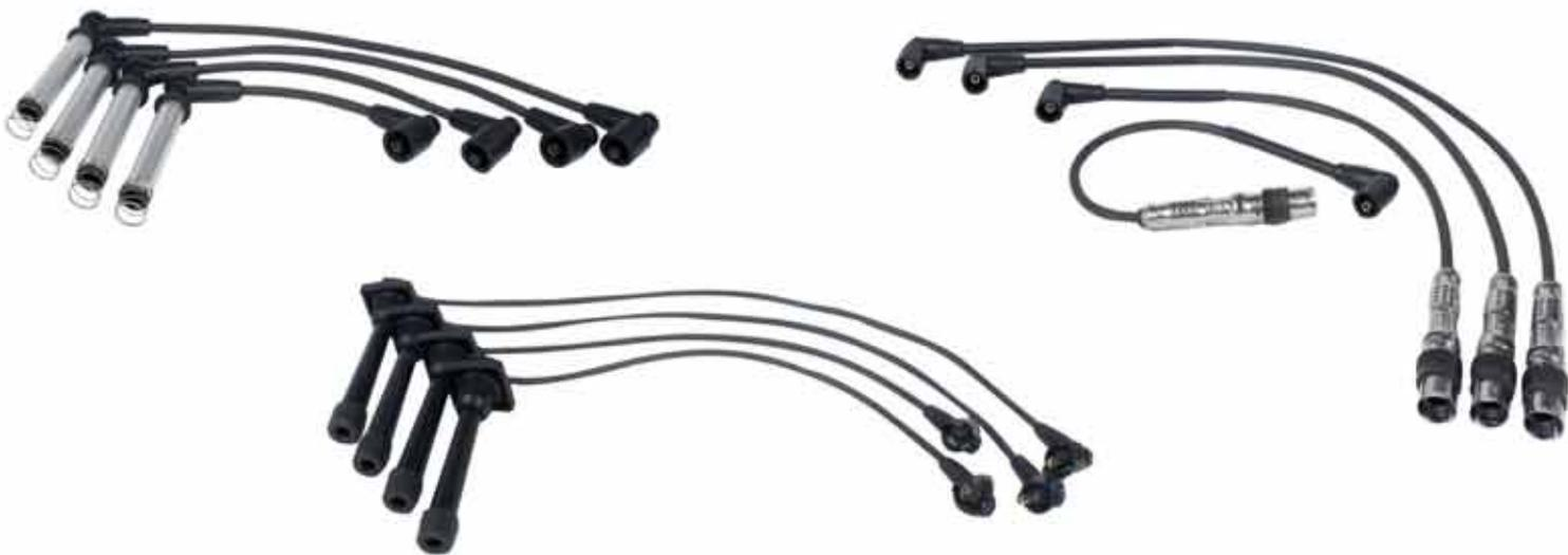
Los cables MAHLE, con núcleo supresor/reactivos son fabricados con filamentos de kevlar o fv impregnados con compuesto silicona/ferromagnético con espiralado en su entorno de hilo de aleación níquel-cromo y con resistencia óhmica entre 4 a 7 Kohms/metro. El sistema espiralado crea una inductancia mejorando la energía de la chispa en la bujía de ignición y anulando las interferencias. Puede ser usado en temperaturas extremadamente bajas (-40 °C) o altas (220 °C).
